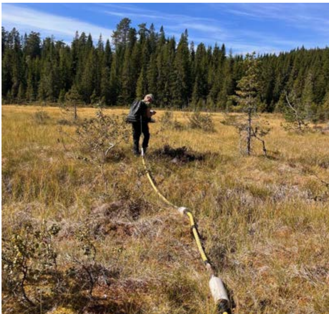
Figur 2-6. Bruk av georadar på Svergekollmyra N ved Blåfjell i Luksefjell (foto: Anne Karen Haukland).
