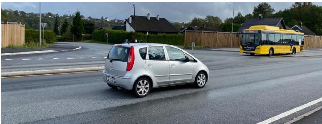
Bilde: 13 Krysset ned til næringsområdet på raset har fått en mer trafiksikker utforming, og østsiden av vegen har fått nytt fortau
