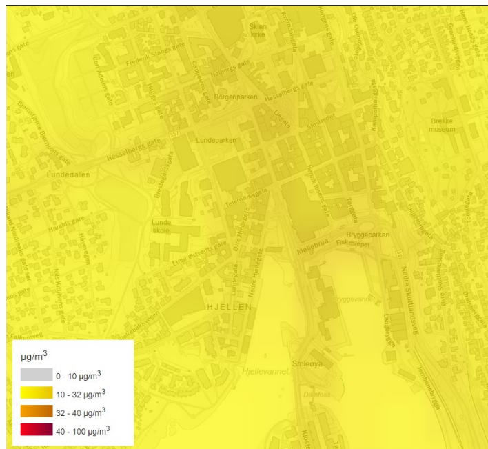
Figur 4-7 - Kartet viser beregnet gjennomsnittlig konsentrasjon i løpet av et år (årsmiddelkonsentrasjon) av nitrogendioksid (NO 2 ). Grenseverdien for årsmiddel av NO 2 er satt til 40 mikrogram per kubikkmeter (µg/m 3 ) i forurensningsforskriften. Kilde: Miljødirektoratets «Fagbrukertjeneste for luftkvalitet» [3.7] (med data hentet fra Meteorologisk institutt / CC-BY-4).
