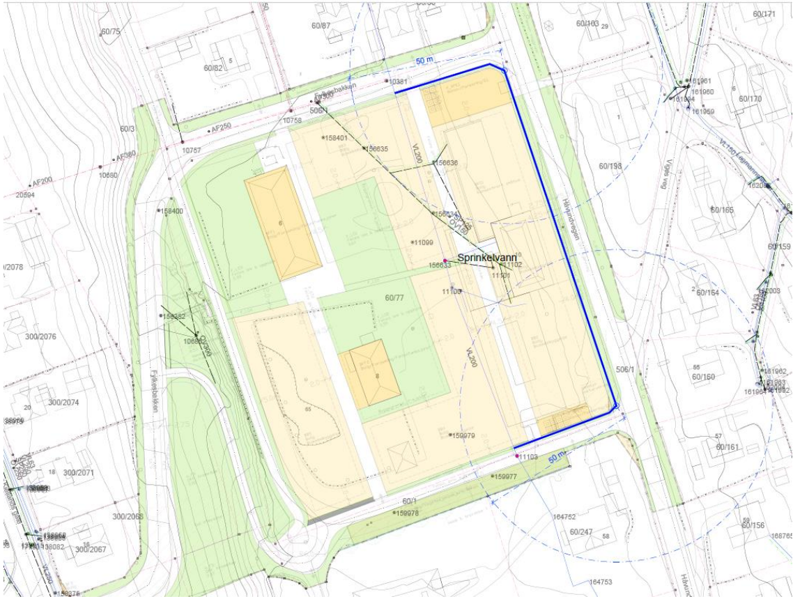
Figur 6.1 viser foreslått ny vannledning inkludert brannkummer.
